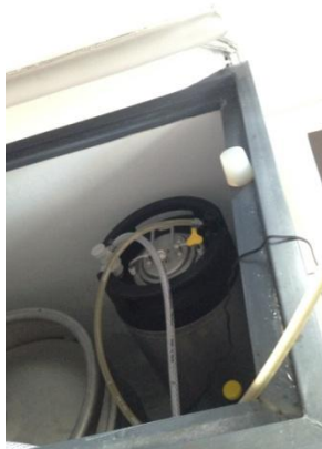
Figura 6: Barril inox sob carbonatação forçada em um refrigerador
