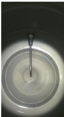
Figura 5: Tina de clarificação com fundo falso
