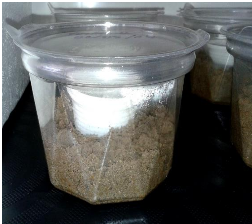
Figura 4 – Reator do experimento de biorremediação. O recipiente no interior foi empregado no ensaio de respiração microbiana
