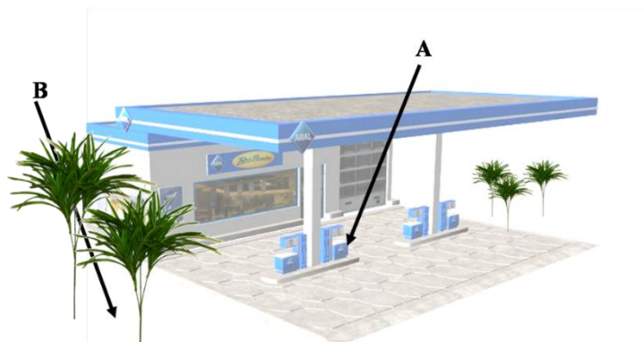
Figura 3 – Pontos considerados para coleta das amostras de solo nos postos de gasolina: área central próxima às bombas (A) e entorno (B).
