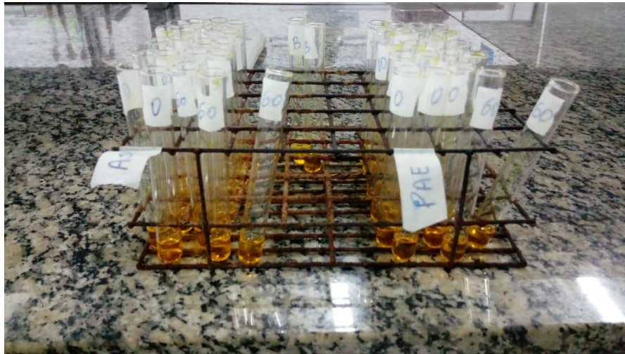
Tubos de ensaio com EB, carboximetilcelulose e DNS. Fonte: Autor, 2018.
