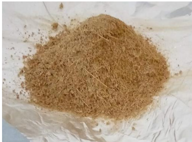
Figura 19 – Pó oriundo da secagem e moagem da casca do coco verde.
