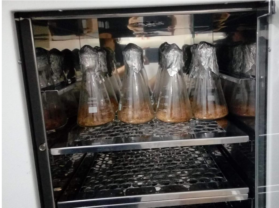
Figura 20 – Frascos erlenmeyers com substrato e inóculo dentro da estufa.
