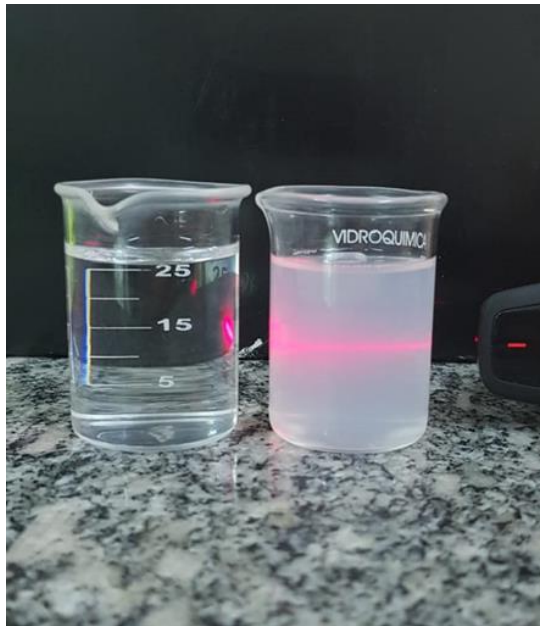
Figura 7 – Demonstração do efeito Tyndall presente na formulação de nanoesferas brancas diluídas (direita) e ausente na água destilada (esquerda)
