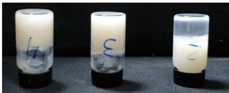
Figura 8 - Teste do Tubo invertido em Hidrogéis de pectina nas concentrações de 2, 3 e 4% (Da direita para a esquerda, respectivamente).
