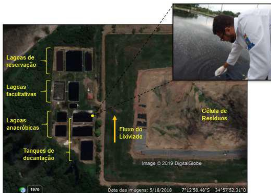
Figura 3 - Coleta do lixiviado no ASMJP em um dos tanques de decantação.
